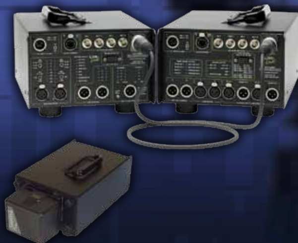
Port pour batterie Anton/Bauer en standard sur l'Unité Caméra ainsi que la version portable de l'Unité de contrôle. Batterie non incluse.
